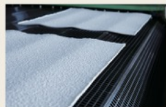
4. 乾燥 成形されたものを乾燥炉に入れ、乾かします。
