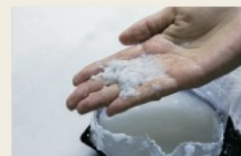
3. 成形 溶解した繊維を金型で抄きあげ、成形します。
