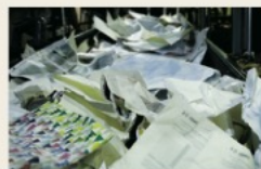
1. 原料 流山工場から届いた損紙がベルトコンベアで運ばれます。
