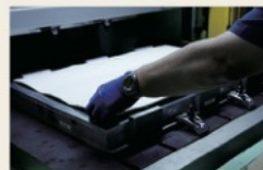
5. プレス 熱をかけてプレスすることで平らに仕上げ、寸法を矯正します。
