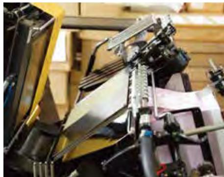
ハイデルベルク社のプラテンという機械で箔を押していくきます。金属製の版を機械にセットし、印刷と箔がずれたりシワが寄ったりしないよう、細心の注意を払いながら仕上げます。紙によって付き方が違うので、テストを繰り返しながら最適な押し方を見極めていきます。
