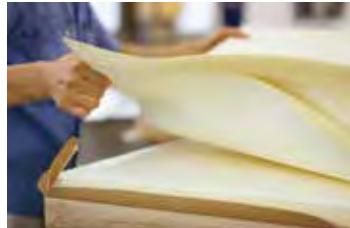
製本工程で特に気を遣うのが断裁。紙の厚さや種類によって、紙が伸びてトンボがずれやすくなります。トンボを合わせてまっすぐ切れるように、断裁前に紙の束の間に空気を入れて積んでいきます。
